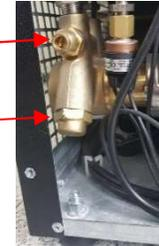
VORSICHT: ein zu geringer Einspritzdruck der Pumpe lässt den Motor und die Pumpe ohne Abschaltung durchgehend laufen, da durch den Gegendruck des CO<sub>2</sub> das Abschaltniveau im Kessel nicht erreicht werden kann.
