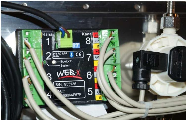
4. Spannungsversorgung für Volumsgeber Digimesa wird von Platine erzeugt und wird bei „Impuls in“ auf 7 Volt abgenommen.
